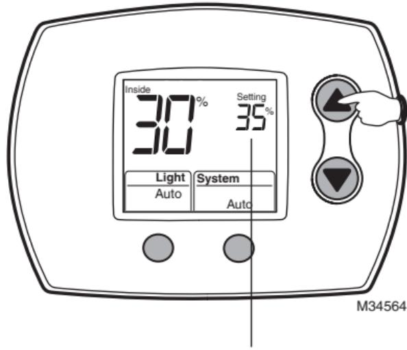
El punto de referencia de humedad destellará si el control de humedad está esperando que finalice el tiempo de protección del deshumidificador.
