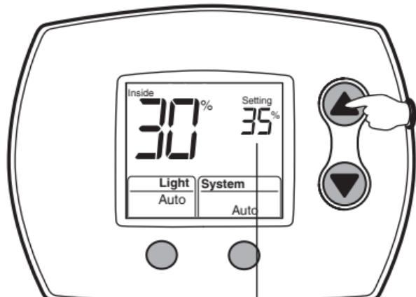
Le point de consigne d'humidité clignote si le régulateur d'humidité attend que la durée de protection du déshumidificateur se soit écoulée.
