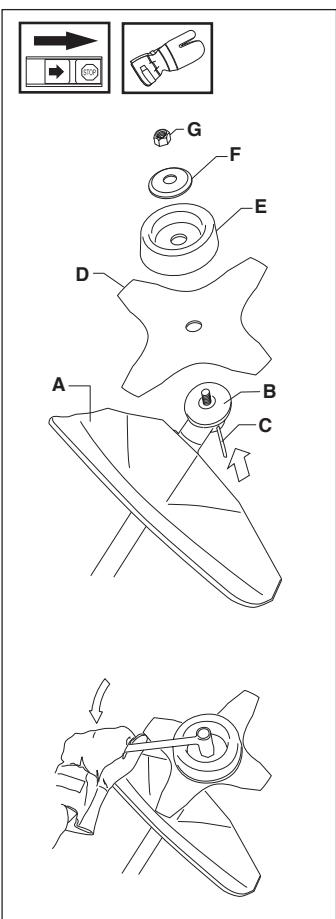
Utiliser la clé à canon du jeu d'outils. Tenir le manche de la clé aussi près du protège-lame que possible. L'écrou se resserre en tournant la clé dans le sens contraire au sens de rotation (l'écrou est fileté à gauche).
