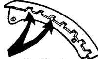
Les bords de la manette doivent se trouver dans ces fentes pour la première position d'enclenchement.
