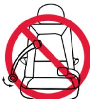
Les ceintures sous-abdominales avec une plaquette cousue munies d'un rétracteur qui ne se bloque qu'en cas d'arrêt brusque.
