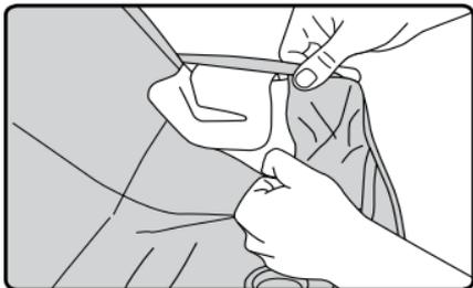
7. Tirez la housse d'around du bouton d'ajustement du harnais et soulevez la housse du siège loin de la coque du siège.
