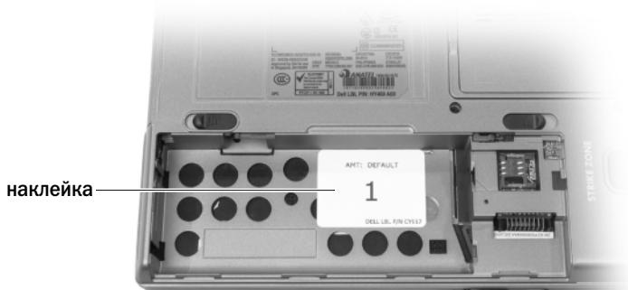
Внутри отсека для аккумулятора должна быть одна из следующих наклеек.
