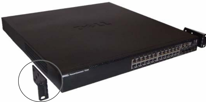
Figura 1-11. Fixação dos suportes
