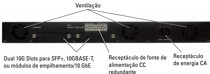
Figura 1-9. Painel traseiro do PC7024P e PC7048P
