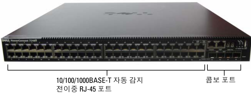
그림 1-6. 48개의 10/100/1000BASE-T 포트가 있는 PowerConnect 7048R
