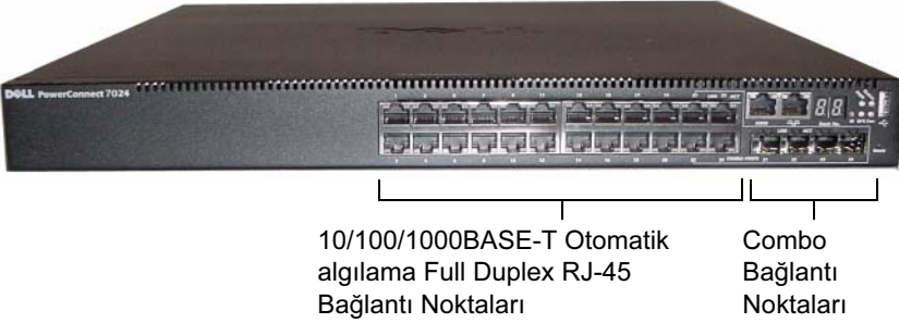
Şekil 1-1. 24 10/100/1000BASE-T Bağlantı Noktalı PowerConnect 7024
