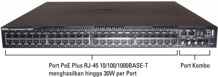
Gambar 1-5. PowerConnect 7048P dengan 48 Port PoE Plus 10/100/1000BASE-T
