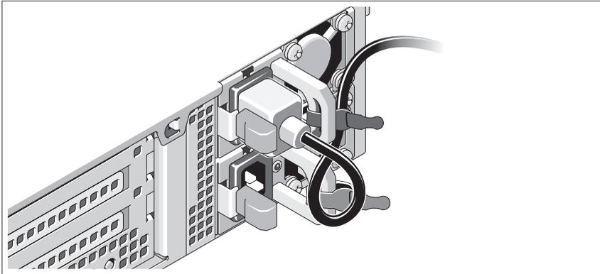
כופף את כבל החשמל של המערכת וצור ממנו לולאה כמו באיור. לאחר מכן חבר את הכבל לתושבת באמצעות הרצועה שסופקה. חבר את הקצה השני של כבל החשמל לשקע חשמל מוארק, או למקור מתח נפרד, כגון מערכת אל-פסק (UPS) או יחידה לחלוקת מתח (PDU).
