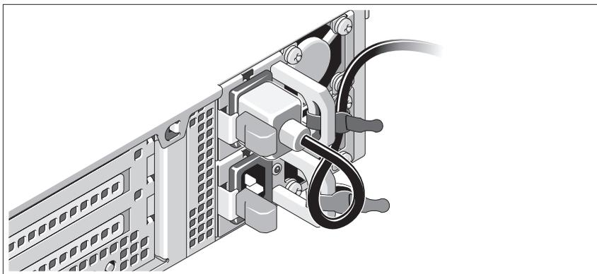
Ohněte napájecí kabel systému do smyčky, jak je znázorněno na obrázku, a připevněte jej dodanou páskou k držáku. Poté zasuňte druhý konec napájecího kabelu do uzemněné elektrické zásuvky nebo jej připojte k samostatnému zdroji napájení, například ke zdroji nepřerušitelného napájení (UPS) nebo jednotce rozvaděče (PDU).
