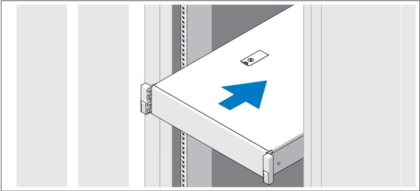
Zamontuj prowadnice i zainstaluj system w szafie typu rack zgodnie z instrukcjami dotyczącymi bezpieczeństwa oraz instrukcjami dotyczącymi instalacji szafy typu rack dostarczonymi wraz z systemem.
