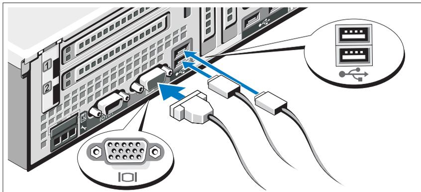
Подключите клавиатуру, мышь и монитор (дополнительно).
