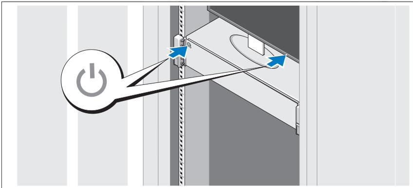
Drücken Sie die Netzschalter am System und am Bildschirm. Die Betriebsanzeigen sollten aufleuchten.
