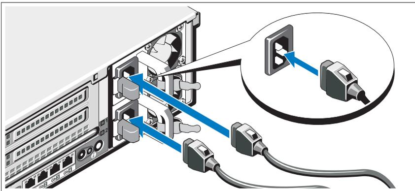
Verbinden Sie die Netzstromkabel mit dem System sowie gegebenenfalls mit dem Bildschirm.
