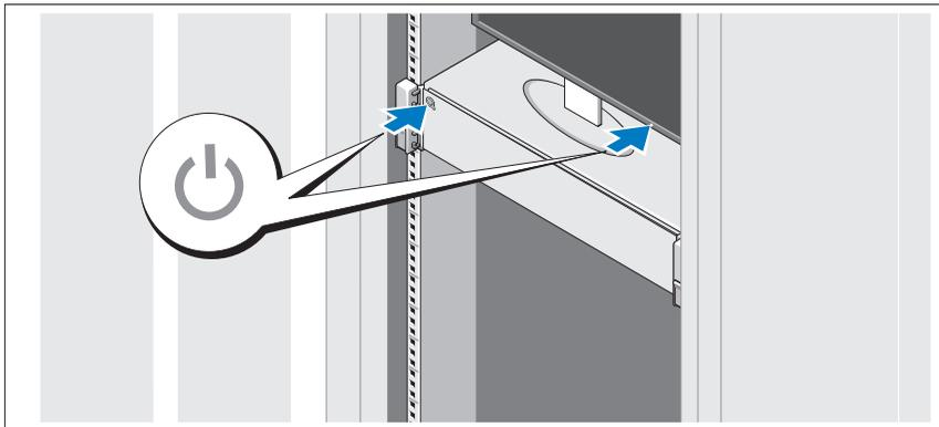
Нажмите кнопки питания на системном блоке и мониторе. Должны загореться индикаторы включения.
