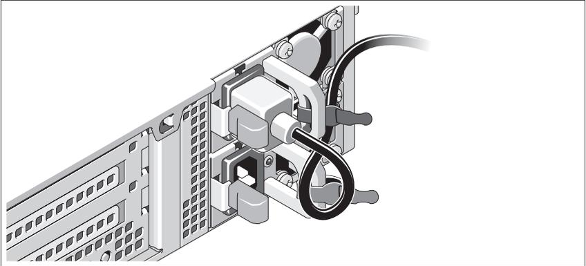
Zegnij kabel zasilania systemu w pętlę, jak przedstawiono na rysunku, i zamocuj kabel na wsporniku, używając załączonej opaski. Podłącz drugą końcówkę kabla zasilania do uziemionego gniazdka elektrycznego lub oddzielnego źródła zasilania, np. do zasilania bezprzerwowego (UPS) lub do jednostki rozdziału zasilania (PDU).
