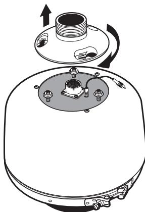
Retirez la plaque de fixation de l'embase : desserrez les écrous situés en haut de l'embase jusqu'à ce qu'ils aient atteint le matériau de blocage situé à l'extrémité des goujons, puis tournez la plaque de fixation dans le sens des aiguilles d'une montre et soulevez-la.
