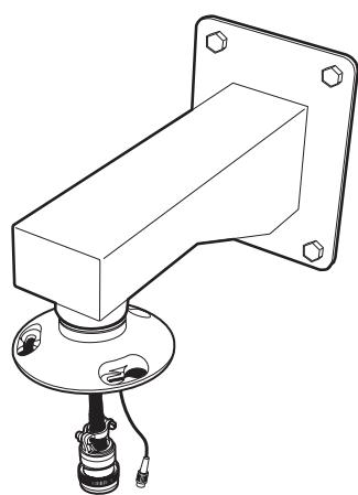
Enfilez le câblage de la fixation dans la plaque de fixation, puis attachez la plaque de fixation sur la fixation. Si l'installation s'effectue à l'extérieur, appliquez le composé pour filetage (fourni) sur le filetage de la plaque de fixation.
