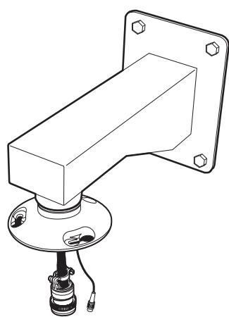
Ziehen Sie die Kabel von der Halterung durch die Montageplatte, und befestigen Sie die Montageplatte an der Halterung. Für den Außeneinsatz schmieren Sie die Gewinde der Montageplatte mit dem im Lieferumfang enthaltenen Gewindefett ein.
