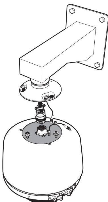
Fixez le connecteur du faisceau de câbles au connecteur apparié situé en haut de l'embase. Connectez le câble à fibres optiques. Insérez les goujons et les écrous situés en haut de l'embase dans la plaque de fixation, tournez l'embase dans le sens inverse des aiguilles d'une montre, puis serrez les trois écrous.
