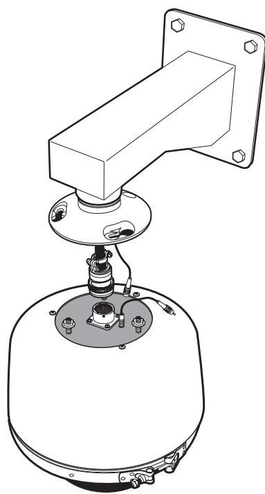
Acople el conector del arnés de cableado al conector que le corresponda ubicado sobre la caja posterior. Conecte el cable de fibra óptica. Inserte en la placa de montaje los pernos y tuercas de la parte superior de la caja posterior, gire la caja posterior en el sentido antihorario, y luego ajuste las tres tuercas.
