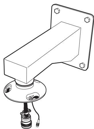
Infilare il cablaggio dalla staffa attraverso la piastra di montaggio e fissare quindi la piastra di montaggio alla staffa. Per applicazioni esterne, applicare del composto (in dotazione) ai filetti della piastra di montaggio.
