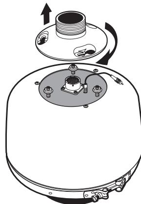
Nehmen Sie die Montageplatte der Back-Box ab: Lösen Sie die Muttern auf der Oberseite der Back-Box bis zum Schraubenende. Drehen Sie die Montageplatte dann im Uhrzeigersinn, und heben Sie sie an.
