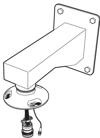
Enrosque el cable de la montura a través de la placa de montaje, y luego acople la placa de montaje a la montura. Si la ubicación es a la intemperie, colóquelas compuesto para roscas (suministrado) a las roscas de la placa de montaje.
