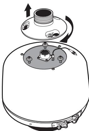
Quite la placa de montaje de la caja posterior: Afloje las tuercas de la parte superior de la caja posterior hasta que alcancen el material de cierre del extremo de los pernos, y después gire la placa de montaje en el sentido de las agujas del reloj y levántela.
