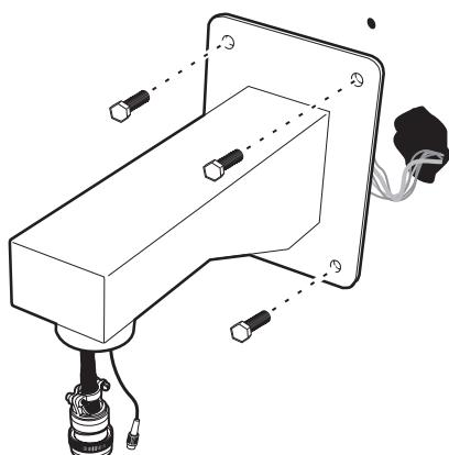
Conecte o cabo de fibra óptica (fornecido) e o módulo de ligação fornecido na entrada da parte frontal do suporte e na saída da parte posterior do suporte. Conecte os cabos conforme necessário. Consulte as Tabelas A, B e C para obter informações sobre os cabos e ligações. Fixe o suporte à superfície de montagem. Consulte as instruções fornecidas com o suporte.
