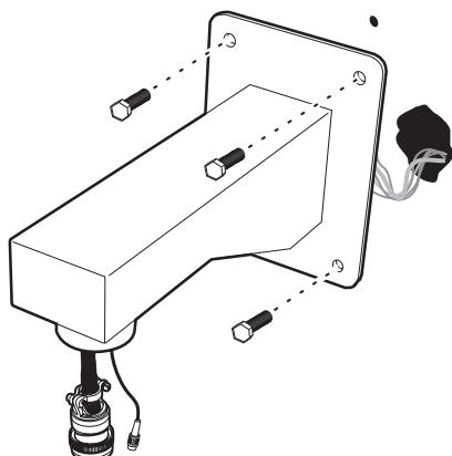
Sitúe un cable de fibra óptica (no suministrado) y el arnés de cableado suministrado desde el frente de la montura y desde atrás de la parte posterior de la montura. Conecte los cables según se requiera. Consulte las Tablas A, B y C para obtener información sobre el cableado. Ajuste la montura a la superficie de montaje. Consulte las instrucciones suministradas con la montura.
