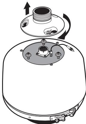
Remova a placa de montagem da back box: solte as porcas da parte superior da back box até que cheguem ao material de bloqueio no final dos parafusos e então gire a placa de montagem no sentido horário e levante-a.
