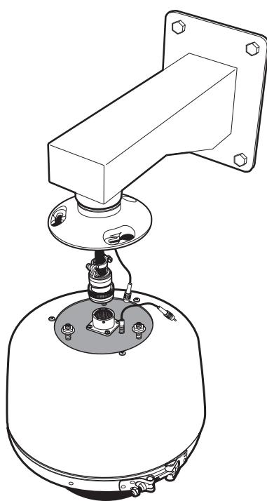
Encaixe o conector do módulo de ligação no conector correspondente, localizado no topo da back box. Conecte o cabo de fibra óptica. Insira os parafusos e porcas através da parte superior da back box até a placa de montagem e então gire a back box no sentido anti-horário e aperte as três porcas.
