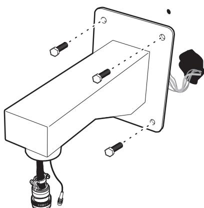
Faites passer un câble à fibres optiques (non fourni) et le faisceau de câbles fourni par l'avant de la fixation et faites-le sortir par l'arrière de celle-ci. Connectez les fils selon le nécessaire. Reportez-vous aux tableaux A, B et C pour les câbles et les fils. Attachez la fixation sur la surface de fixation. Reportez-vous aux instructions fournies avec la fixation.
