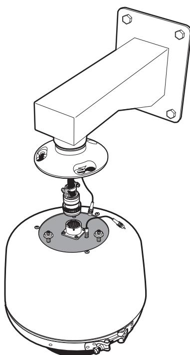
Fissare il connettore di cablaggio a quello corrispondente situato sulla sommità del contenitore. Collegare il cavo a fibre ottiche. Inserire le viti ed i dati sulla sommità del contenitore nella piastra di montaggio, ruotare il contenitore in senso antiorario e quindi serrare i tre dadi.
