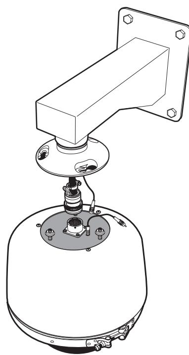
Schließen Sie den Anschluss des Kabelsatzes an den entsprechenden Anschluss an der Oberseite der Back-Box an. Schließen Sie das Faseroptikkabel an. Legen Sie die Schrauben und Muttern an der Oberseite der Back-Box in die Montageplatte ein, drehen Sie die Back-Box gegen den Uhrzeigersinn, und ziehen Sie die drei Muttern fest.
