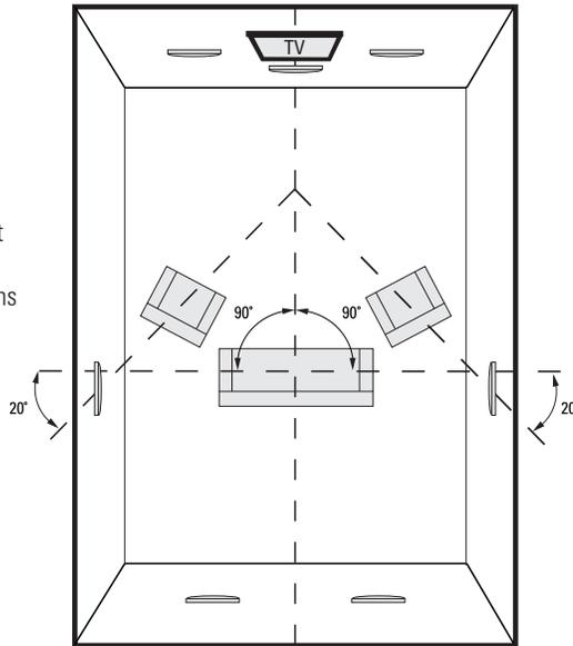
**Das Diagramm zeigt die Lautsprecherpositionen für 5.1- und 7.1-Systeme, wobei zwei zusätzliche Lautsprecher in der hinteren Wand installiert werden.**
