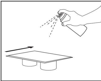
3. Sprühen Sie eine dünne, gleichmäßige Lackschicht auf eine Seite des Grills und bewegen Sie dann die Sprühdose am Rand des Grills entlang, um sicherzustellen, dass Sie den Rahmen abdecken.
