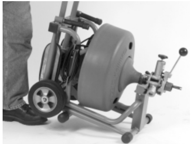
Figura 7 – Incline la máquina hacia adelante para desenganchar la barra apoyapiés
