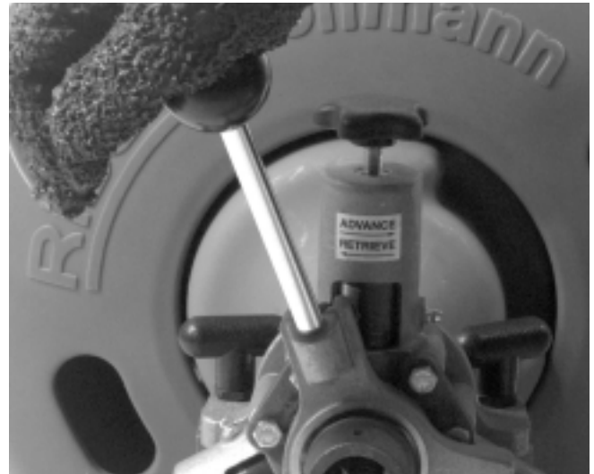
Figura 9 – Funcionamiento de la palanca de autoalimentación
