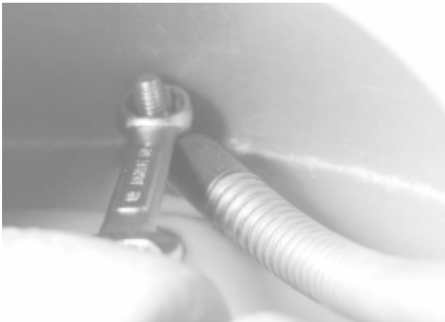
Figure 14 – Retrait du boulon de retenue du raccord flexible
