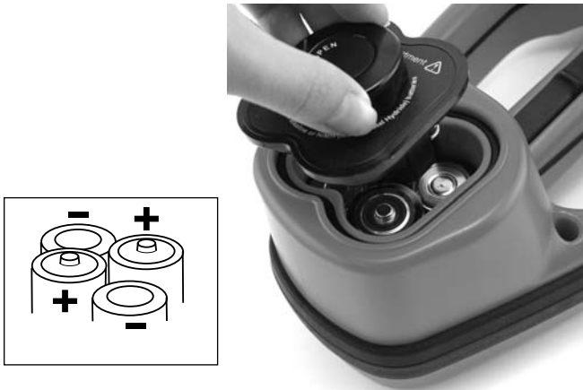
Figura 4 – Compartimiento de las pilas
