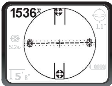
Figure 23 – Localisation de sonde : l'équateur
