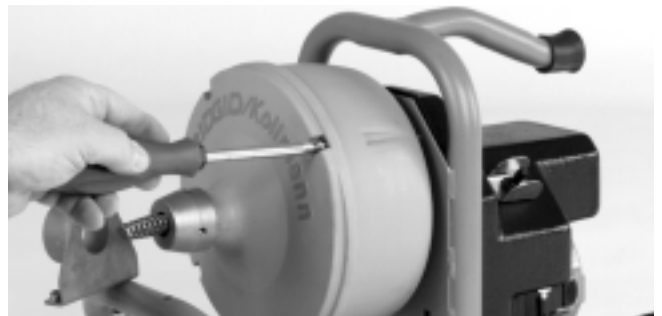
Figura 18 – Afloje los cuatro tornillos unas tres vueltas completas pero no los saque
