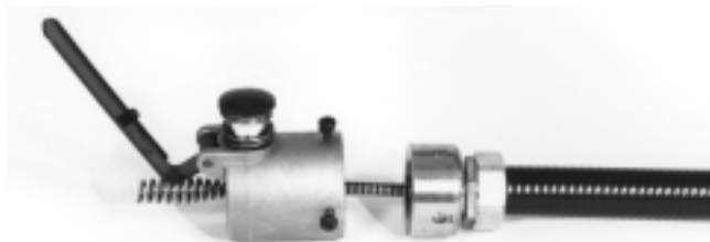
Figure 9 – Montage du système d'entraînement automatique sur le tuyau de guidage
