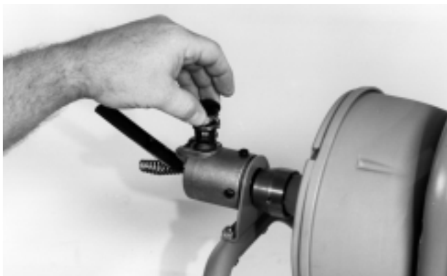
Figura 7 – Se muestra la autoalimentación acoplada directamente en el Soporte para el montaje
