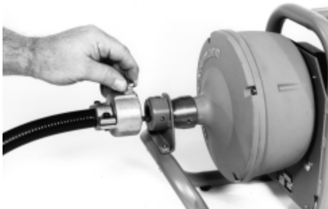
Figure 8 – Montage du tuyau de guidage sur le support
