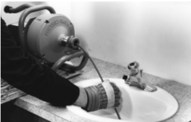
Figure 15 – Enfoncez le câble dans l'évacuation tout en gardant l'autre main près de l'entrée de l'évacuation.
