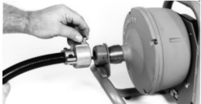
Figura 8 – Acoplamiento de la manguera guía al brazo de montaje
