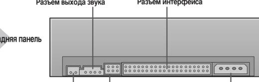
Разъем выхода звука, Разъем интерфейса, Разъем выхода цифровых данных, Разъем переключения ведущий/ведомый, Разъем подключения питания. Принадлежности: Руководство по эксплуатации, Четыре винта для установки привода.
