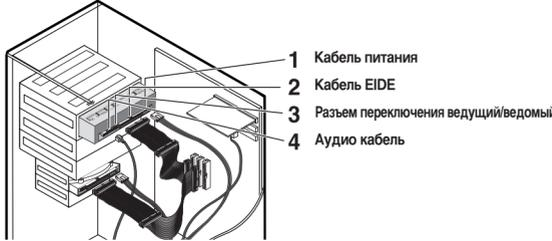
1 Подсоединение кабеля питания. 4-х контактный кабель питания от внутреннего блока питания компьютера должен быть подсоединен разъему питания на задней панели DVD Writer.
