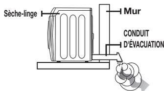
2. Utilisez un conduit d'évacuation métallique rigide de 10,2 cm. Scellez tous les joints à l'aide d'un ruban en aluminium, y compris au niveau du sèche-linge. N'utilisez jamais de vis, qui entraînent l'accumulation de peluches.
