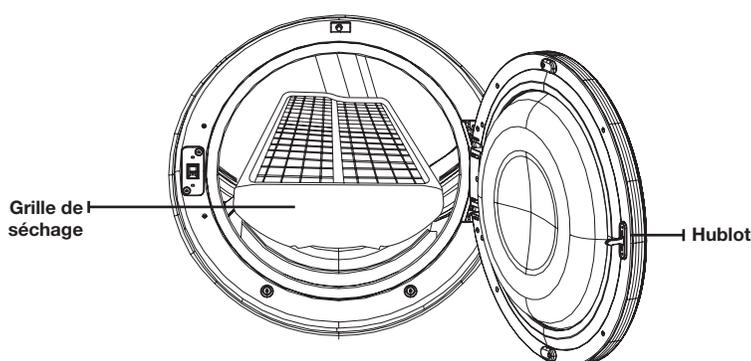
la durée en fonction de l'humidité et du poids du linge. La grille de séchage peut également être utilisée en mode Flux d'air.
