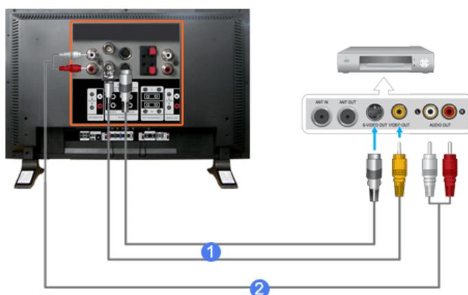
1) Les périphériques d'entrée AV comme les magnétoscopes ou caméscopes sont branchés sur le terminal **AV IN [VIDEO]** ou **AV IN [S-VIDEO]** du moniteur au moyen du câble S-VHS ou BNC.
