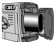
【 Inserting the CR-V3 type battery 】
