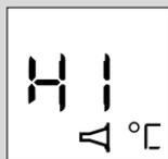
La temperatura rilevata è al di fuori del intervallo di temperatura visualizzato (20°C-42,2°C).
