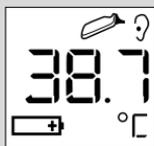
De batterijen zijn bijna leeg, maar de thermometer kan nog steeds correct de temperatuur opnemen. (Geen lichtfunctie)
