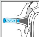
Braun ThermoScan misst die Infrarot-Wärme, die vom Trommelfell und dem umliegenden Gewebe abgegeben wird. Um ein genaues Messergebnis zu erzielen, führt das Thermometer in einer Sekunde 8 Messungen durch und zeigt die höchste Temperatur an.
