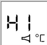
La température relevée n'est pas comprise dans l'intervalle de températures affiché (20°C - 42,2°C).
