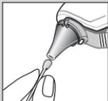
Om de lens te reinigen wrijft u zachtjes over het oppervlak met een wattenstaafje, bevochtigd met alcohol. Wrijf de lens vervolgens onmiddellijk droog met een schoon wattenstaafje. Na het reinigen minstens 5 minuten laten drogen voordat u weer temperaturen opneemt. Controleer of de lens van de sonde schoon en droog is. Vermijd aanraking van de lens, behalve wanneer het dient te worden gereinigd. Bij beschadiging van de lens dient u de thermometer naar Welch Allyn te sturen voor controle.
