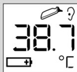
La pila si sta esaurendo, ma il termometro funzionerà ancora correttamente (non funziona la luce del display).
