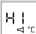
Gemessene Temperatur liegt außerhalb des anzeigbaren Temperaturbereiches (20°C - 42,2°C).
