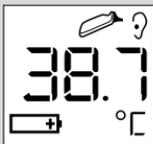
Les piles sont faibles mais le thermomètre fonctionne correctement (pas de fonction d'éclairage de l'écran).
