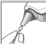
Zum Reinigen die Oberfläche der Linse vorsichtig mit einem in Alkohol getränkten Wattestäbchen abwischen und sofort mit einem neuen Wattestäbchen trockenwischen. Nach dem Reinigen noch 5 Minuten nachtrocknen lassen, bevor wieder Messungen vorgenommen werden. Die Messlinse muss sauber und trocken sein. Außer beim Reinigen sollte die Linse nicht berührt werden. Ist die Linse beschädigt, muss das Thermometer an den Welch Allyn Kundendienst eingeschickt werden.
