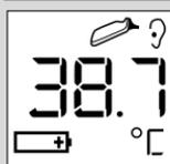
Batterie ist schwach, aber korrekte Messungen können noch durchgeführt werden. (Keine Anzeigen-Beleuchtung mehr)
