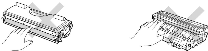
6. Coloque o novo cartucho de toner na unidade do tambor, até que o cartucho fique encaixado na unidade. Quando o cartucho do toner estiver correctamente encaixado, a alavanca de bloqueio sobe automaticamente.
