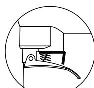
Après avoir vérifié qu'il n'y a pas d'attache dans l'outil, faire une vérification de sécurité du fonctionnement du verrou de gâchette activé pour éviter le déclenchement d'une attache de l'outil avant le rangement. Toujours débrancher de l'air comprimé lorsque l'appareil n'est pas utilisé.
