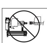
**AVERTISSEMENT** *Toujours débrancher l'outil de la source de courant en votre absence, en effectuant des réparations ou son entretien, en débloquant l'appareil ou en le déplaçant ailleurs. Ne pas charger l'outil d'attachments lorsque la gâchette est enfoncée. L'éjection accidentelle d'une attache peut causer des blessures graves ou mortelles.*
