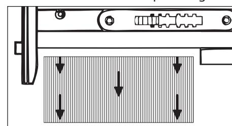
4. Empuje la tapa del cargador hacia adelante hasta que quede con traba.
