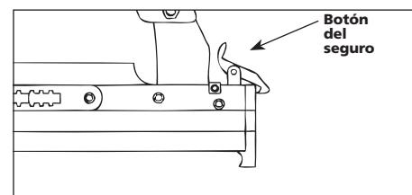
3. Introduzca una tira de sujetadores en el cargador con las puntillas colocadas como se indica. Cercírese de que las puntillas no estén sucias ni dañadas. Las puntillas llevan una marca con la dirección para cargar.
