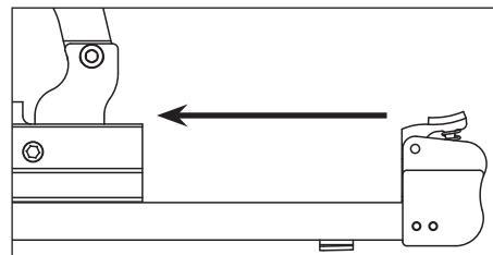
5. Toujours décharger toutes les attaches avant de cesser d'utiliser l'outil. Décharger est le contraire de charger, sauf qu'il faut toujours débrancher l'alimentation d'air avant de décharger.
