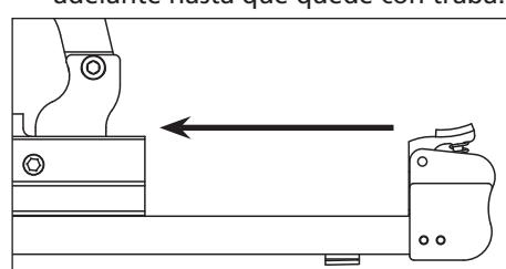
5. Siempre descargue el sujetador antes de remover la herramienta de servicio. La descarga se hace siguiendo el proceso inverso de la carga; sin embargo, siempre se tiene que desconectar la manguera de aire antes de descargarla.
