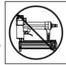
**DANGER** *Ne toucher à la gâchette qu'au moment de poser des attaches. Ne jamais actionner la gâchette durant le transport de l'outil ou durant le raccordement de celle-ci au tuyau d'air comprimé. L'éjection accidentelle d'un outil peut causer des blessures graves ou mortelles. Activer aussi le protecteur de gâchette à une position sans danger lorsque l'appareil n'est pas utilisé.*
