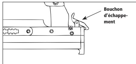
3. Insérer un bâtonnet d'attaches dans le chargeur avec les goupilles placées comme illustré. S'assurer que les goupilles ne sont pas sales ou endommagées. Les goupilles sont marquées pour la direction de chargement.
