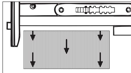
4. Enfoncer le couvercle du chargeur vers l'avant jusqu'à ce que le loquet s'engage.
