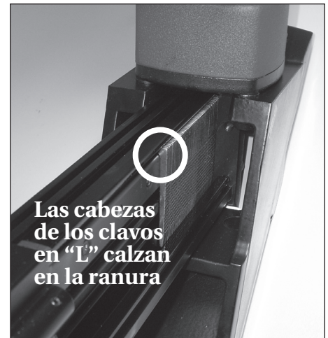
Figura 19 - La cabeza del clavo en "L" debe calzar en la ranura del cargador fijo
