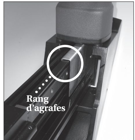
Figure 17 - Placer les agrafes pour chevaucher le dessus du chargeur.
