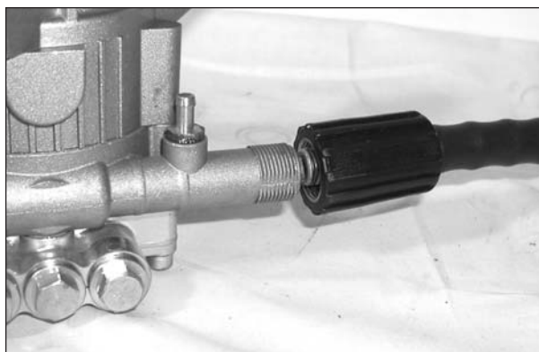
Figura 5 - Conecte la manguera de alta presión a la bomba
