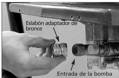
Figura 4 - Conecte el eslabón adaptador a la bomba
