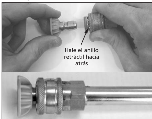
Figura 7 - Instalación de la boquilla de conexión rápida
