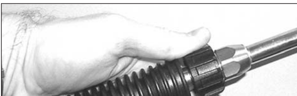
Figura 6 - Conecte la lanza a la pistola
