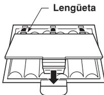
El teclado puede no funcionar correctamente si coloca o cambia las pilas con la alimentación activada. Si esto llega a ocurrir, desactivando la alimentación del teclado y luego volviendo a activar de nuevo deberá retornar el funcionamiento a su condición normal.
