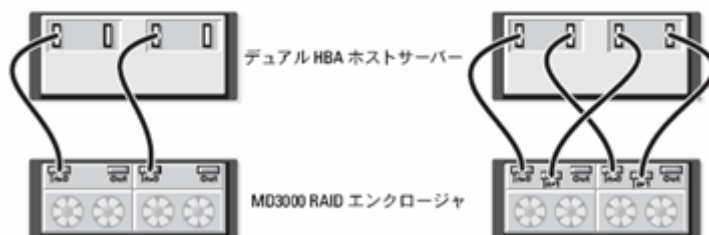
冗長データバスを使用した単一ホストのケーブル接続
