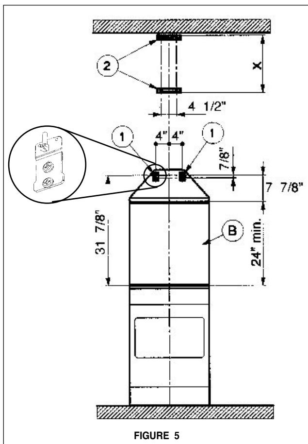
4. La cheminée s'installe au mur par deux fixations (**2 de la FIGURE 5**). Noter la position des fixations. La fixation supérieure doit être installée à environ 1/8 po du plafond. La fixation inférieure doit être installée au point inférieur du manchon de la cheminée supérieure.
