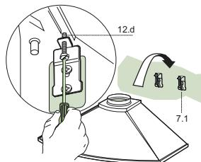
**Note :** Le corps de hotte doit être fixé aux goujons muraux. Si nécessaire, installer un support en bois derrière le mur sec, monté à ras des 2 goujons. Cela assurera la structure requise et le support de montage.
