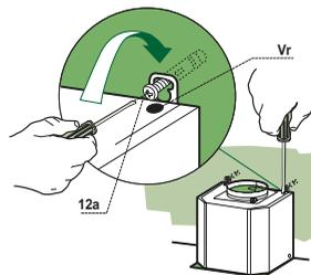
**Note:** Le corps de la hotte devrait être fixé au poteau mural. Si nécessaire, installer un support en bois derrière la paroi sèche, à mi-chemin entre deux poteaux muraux. Cela fournira la structure et le soutien nécessaire au montage.
