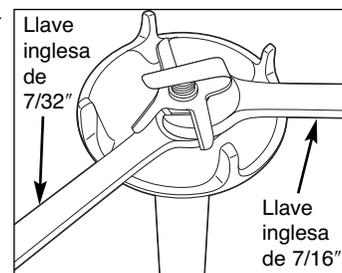
2. Mientras sostiene el eje en su lugar, use una llave inglesa 7/16" para girar las cuchillas en el **sentido del reloj** para aflojar las cuchillas.
