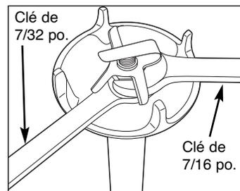
3. Quand vous remettez les lames, vissez la tête de coupe dans l'arbre **dans le sens opposé à celui des aiguilles d'une montre** et assurez-vous qu'elles soient bien serrées en place.
