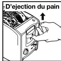
la manette pour mettre le grille-pain en fonctionnement. La manette peut être soulevée jusqu'au sommet pour interrompre le grillage durant un cycle. Pour soulever, placer l'index sous la manette et le pouce sur le bord du grille-pain directement au-dessus de la manette.
