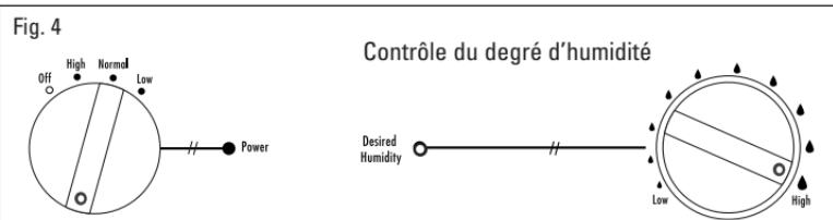
**REMARQUE:** Si le ventilateur de l'humidificateur ne se met (ou remet) pas en marche une fois que la commande de vitesse du ventilateur a été réglée à la position désirée, il se peut que le bouton de contrôle du degré d'humidité soit réglé trop bas. Tourner le cadran dans le sens des aiguilles d'une montre jusqu'à la gouttelette la plus grosse (💧) avant la position « High ». Le voyant d'HUMIDITÉ DÉSIRÉE (DESIRED HUMIDITY) s'éteint lorsque l'appareil produit de la vapeur (Fig. 4).
