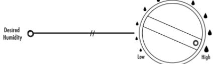
**NOTA:** Si el ventilador del humedecedor no enciende o vuelve a encender después de que haya sido seleccionado una velocidad, es posible que tiene fijado el Regulador de Humedad demasiado bajo. Gire el interruptor en el sentido de las manecillas del reloj ↗ hasta el punto negro más grande (●). La lámpara de Humedad Deseada estará apagada (OFF) cuando la unidad está disipando humedad (Fig. 4).
