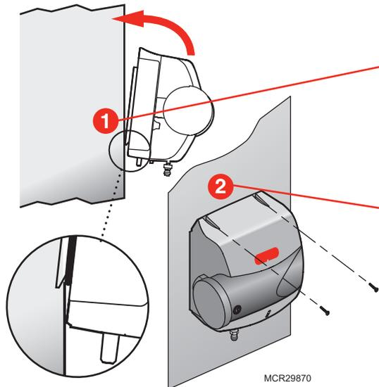
Attachez les crochets de support des modèles à dérivation sur le bord inférieur de l'orifice.
