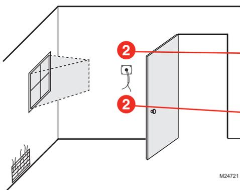
Coupez un trou de 1 po de diamètre dans le mur pour le fil.
