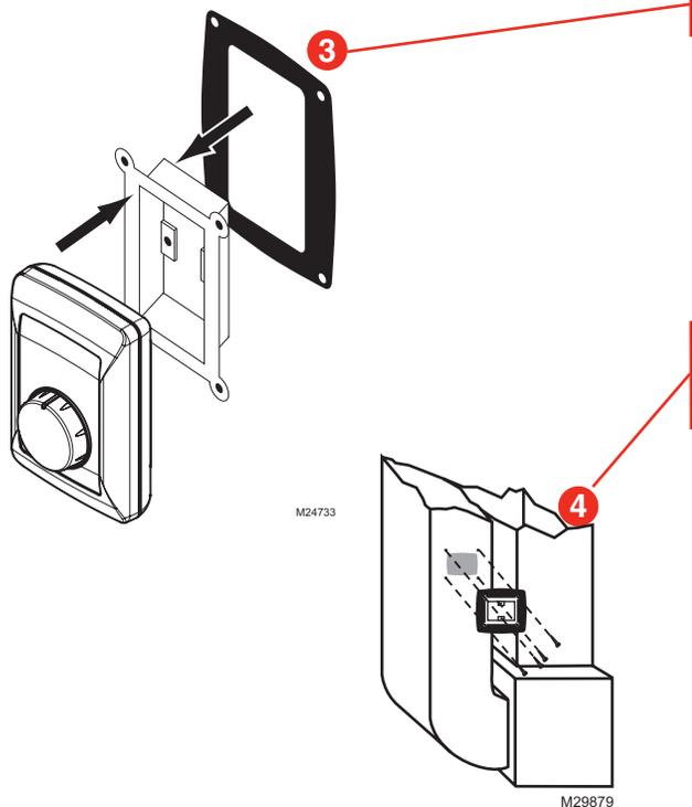
Retirez le support de base de l'humidistat. Glissez le joint noir sur le support de base.
