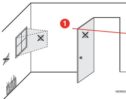
Choisissez un emplacement dans une pièce habitable. Sélectionnez un emplacement à l'abri des courants d'air et d'une humidité excessive. Évitez le montage près de portes, de fenêtres, ou dans des salles de bains ou des cuisines.
