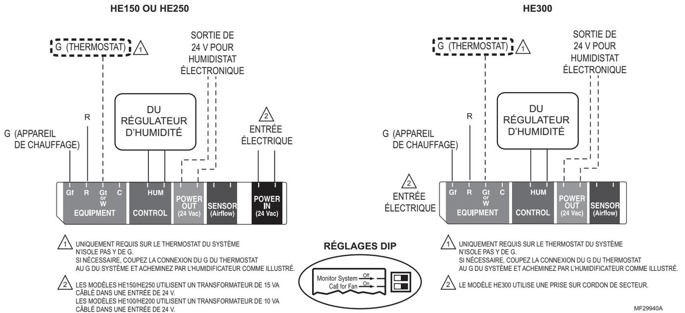
Câblage pour forcer le ventilateur et vérifier la présence d'air dans la gaine.
