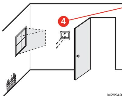
Poser la plaque de montage sur à l'emplacement choisi dans la pièce. Fixer au mur avec les deux vis de 25 mm (1 po) fournies.
