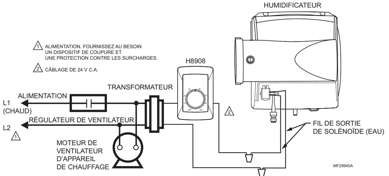
Câblage du modèle H8908 avec moteur de ventilateur deux vitesses.
