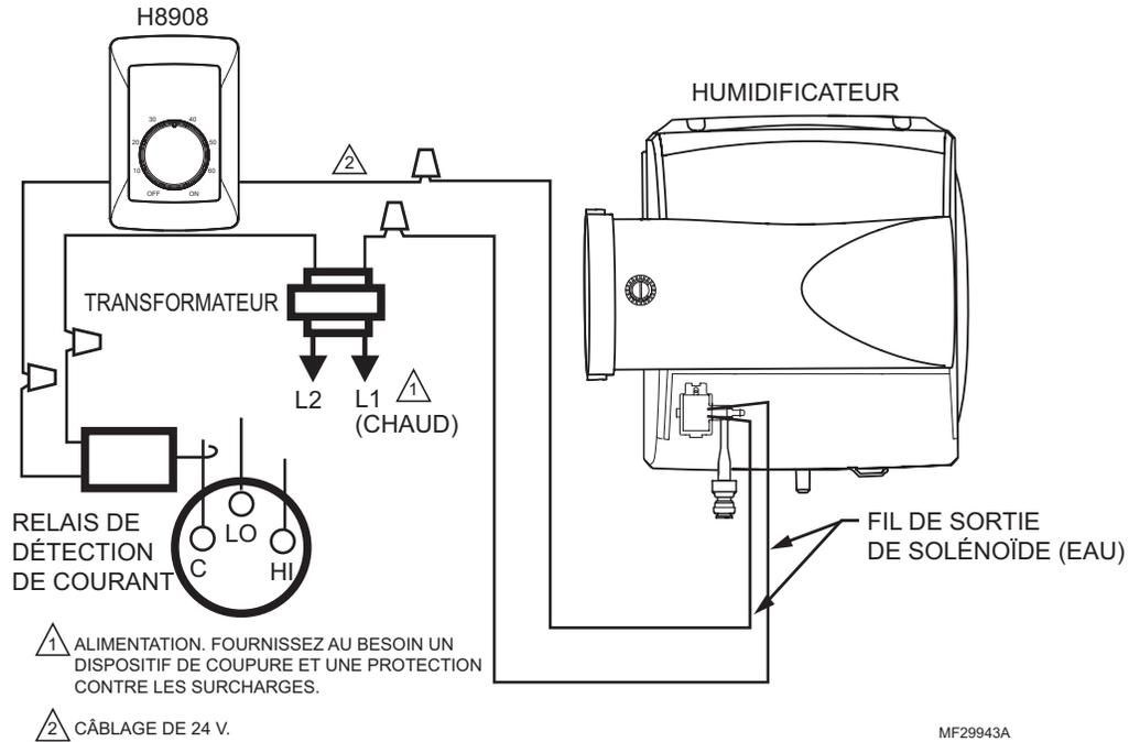
Câblage en ligne du modèle H8908 avec dispositif de vérification de présence d'air.
