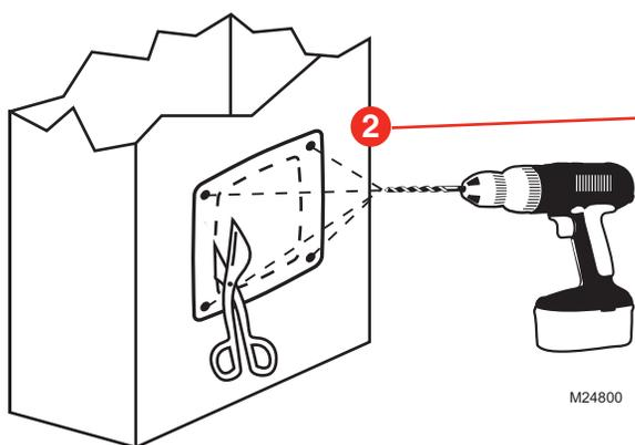
Appliquez un gabarit adhésif sur la gaine et les orifices de perçage pour les vis de montage. Coupez le long des pointillés du gabarit avec des cisailles à tôle.
