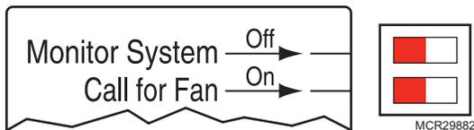
**DIP 1 (haut):** Ce commutateur recherche les entrées du système de CVCA avant de permettre l'humidité. Réglé à gauche, l'humidificateur recherchera une/des entrée(s). Réglé à droite, il n'en recherchera pas.
