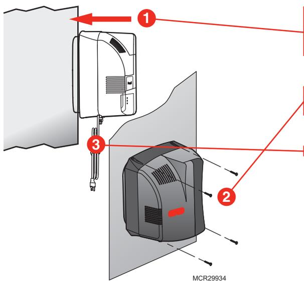
Faites glisser le modèle à ventilateur uniformément dans l'orifice de la gaine. Vérifiez que l'humidificateur est à niveau.
