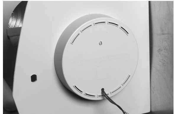
Fig. 22. Installation du couvercle du moteur.
