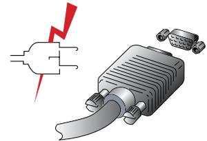
1. Schließen Sie den anderen 15-poligen DVI-D/HDMI-Signalkabelstecker an der 15poligen VGA/DVI-D-Buchse Ihres Computers an, und ziehen Sie die Schrauben an.
